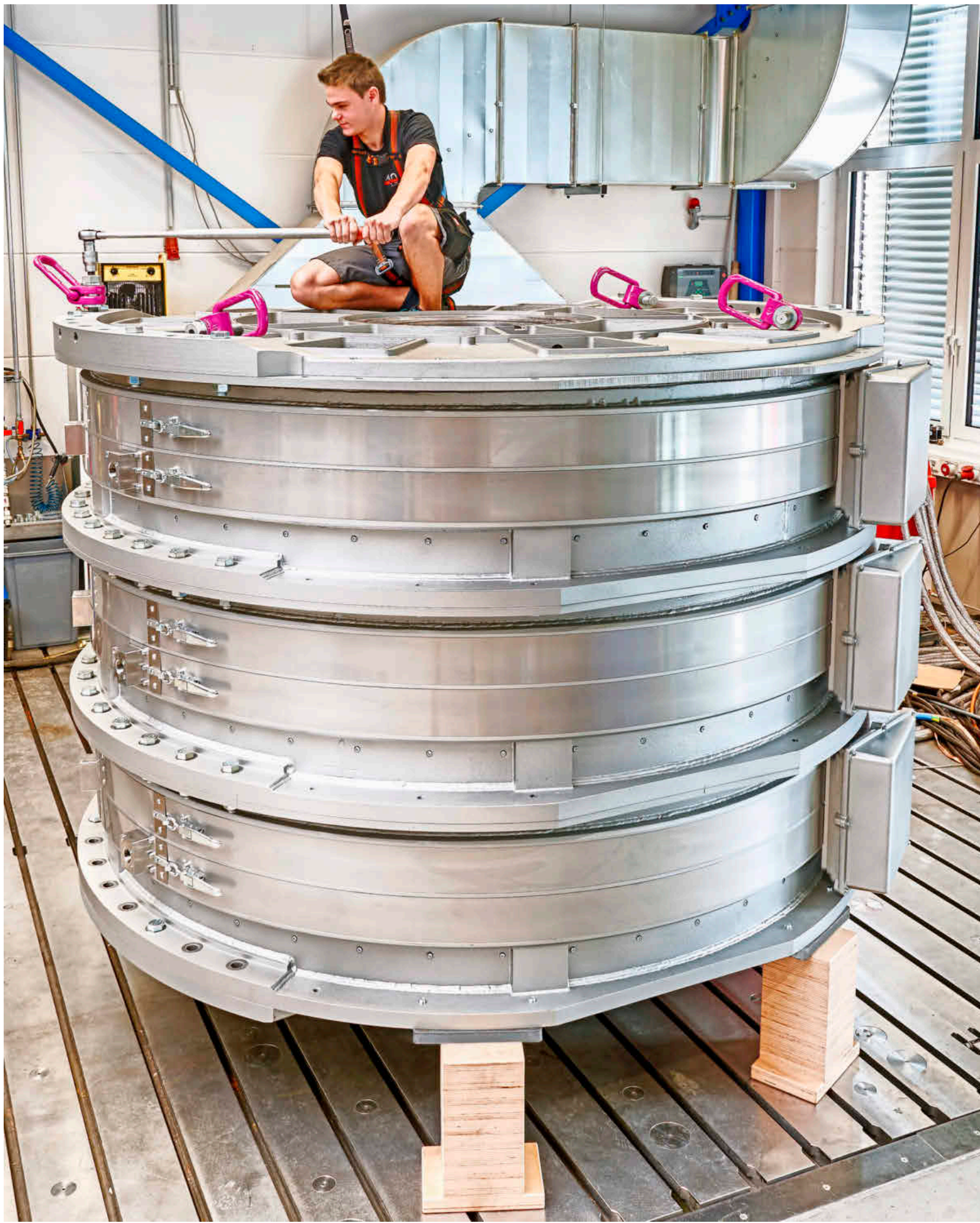
Oswald-Mitarbeiter Maurice Hennig zieht die letzten Schrauben am stärksten Elektromotor, den die Miltenberger Motorenschmiede bislang gebaut hat, fest. Foto: Thomas Maier
