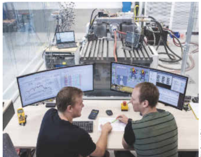
Jeder Schiffsmotor muss zur Abnahme mit Lloyd's Register auf den hauseigenen Prüfstand.
