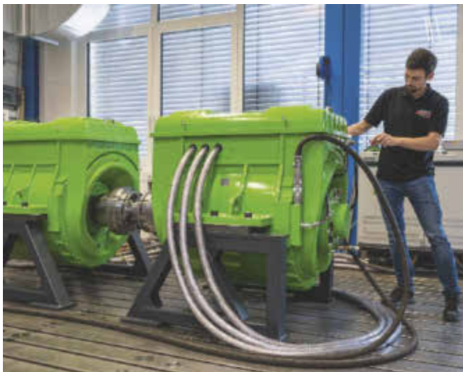
Die Schiffsmotoren im neu designten Gehäuse auf dem Oswald-Prüfstand zur Abnahme.
