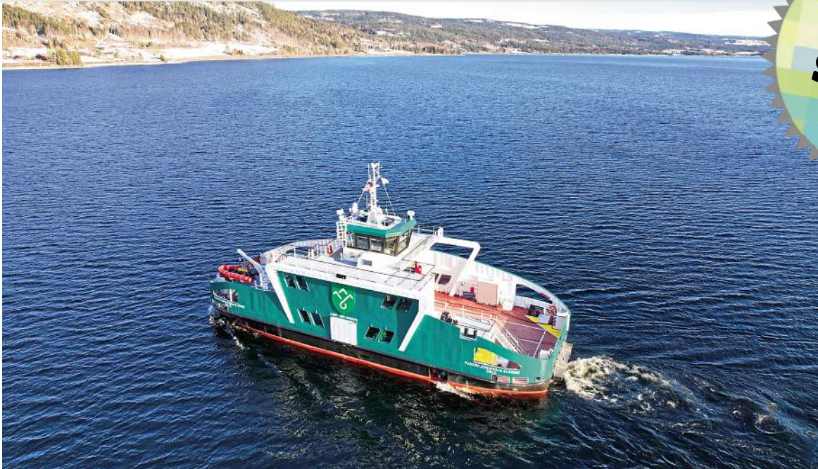
Vollelektrische, emissionsfreie Fähre „Elrond“ in Norwegen mit Oswald-Motoren.
