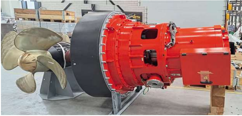
Thrusterantrieb 2025: Leistung [P] = 895 kW, Drehzahl [n] = 900 rpm, Wirkungsgrad [eta] = 98,1 %
